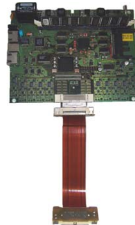
Permet d'effectuer des mesures dans des conditions de température élevées: -40°C à 80°C. Modèle présenté en format "carte seule" sans boîtier avec départ du connecteur de sondes
