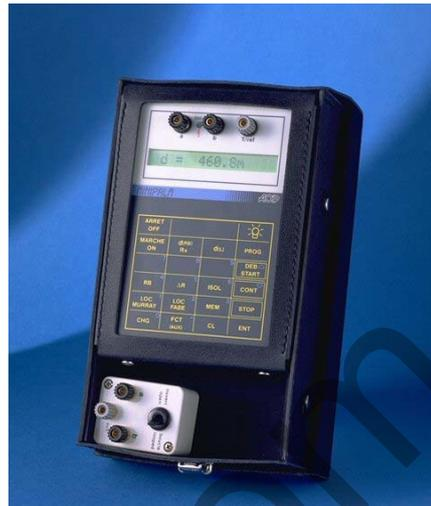
Le localisateur de défauts MINIPALM est destiné à rechercher la position des défauts d'isolement sur les câbles de transmission. Il permet également d'effectuer les mesures de résistance de boucle, de résistance d'isolement, de déséquilibre de résistance  $\Delta R$ .
