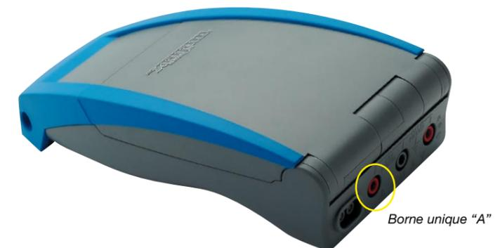
Afin d'améliorer l'efficacité et la sécurité lors des interventions, l'instrument ne comporte que 3 bornes de mesure. Lors de la connexion du cordon mobile sur la borne "Ampère" ou sur la borne "Volt", la fonction correspondante est automatiquement sélectionnée en mode AC+DC, en gamme automatique par défaut, réduisant ainsi les manipulations au minimum.
