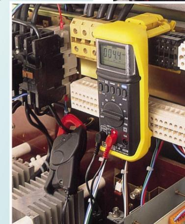
▲ Sur une platine électronique, contrôle d'une tension déformée avec le C.A 5240G. La pointe de touche fixée au dos de la gaine facilite la prise de mesure.
