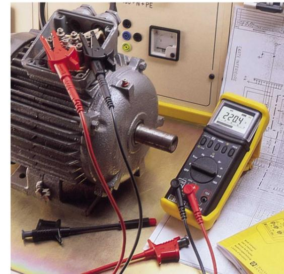
▲ Test de contrôle sur la plaque à bornes d'un moteur électrique triphasé avec le C.A 5220G.
