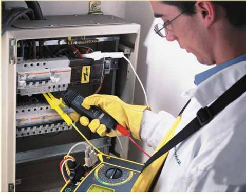
Un cordon de mesure tripode (L, N, PE) terminé par des pinces crocodiles ou pointes de touche sert à effectuer chaque mesure individuellement directement sur les conducteurs.
