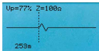
Mapper™ Pro C.A 7026 graphique sont des réflectomètres temporels portatifs (TDR) pour câbles blindés, coaxiaux et télécoms sur une distance maximale respective
