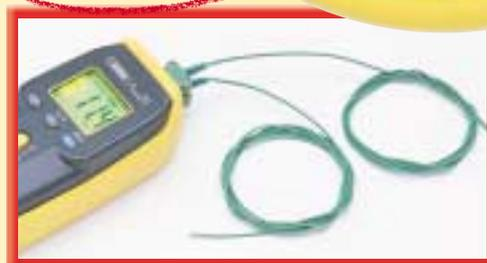
Livré avec 2 capteurs souples thermocouple K
